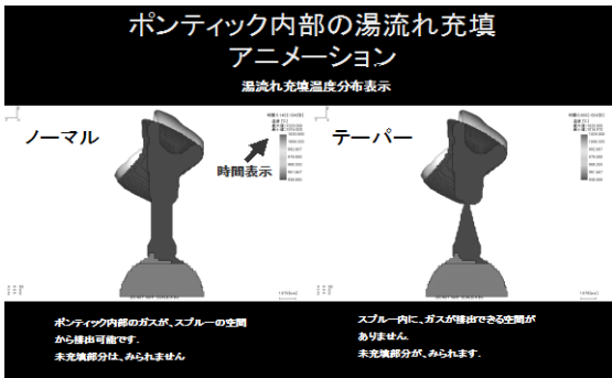
図6. ポンティック内部の湯流れ充填アニメーション
