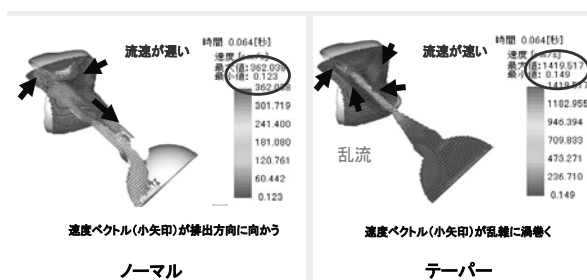
図4. 湯流れ充填速度表示 (ノーマルとテーパの比較)
